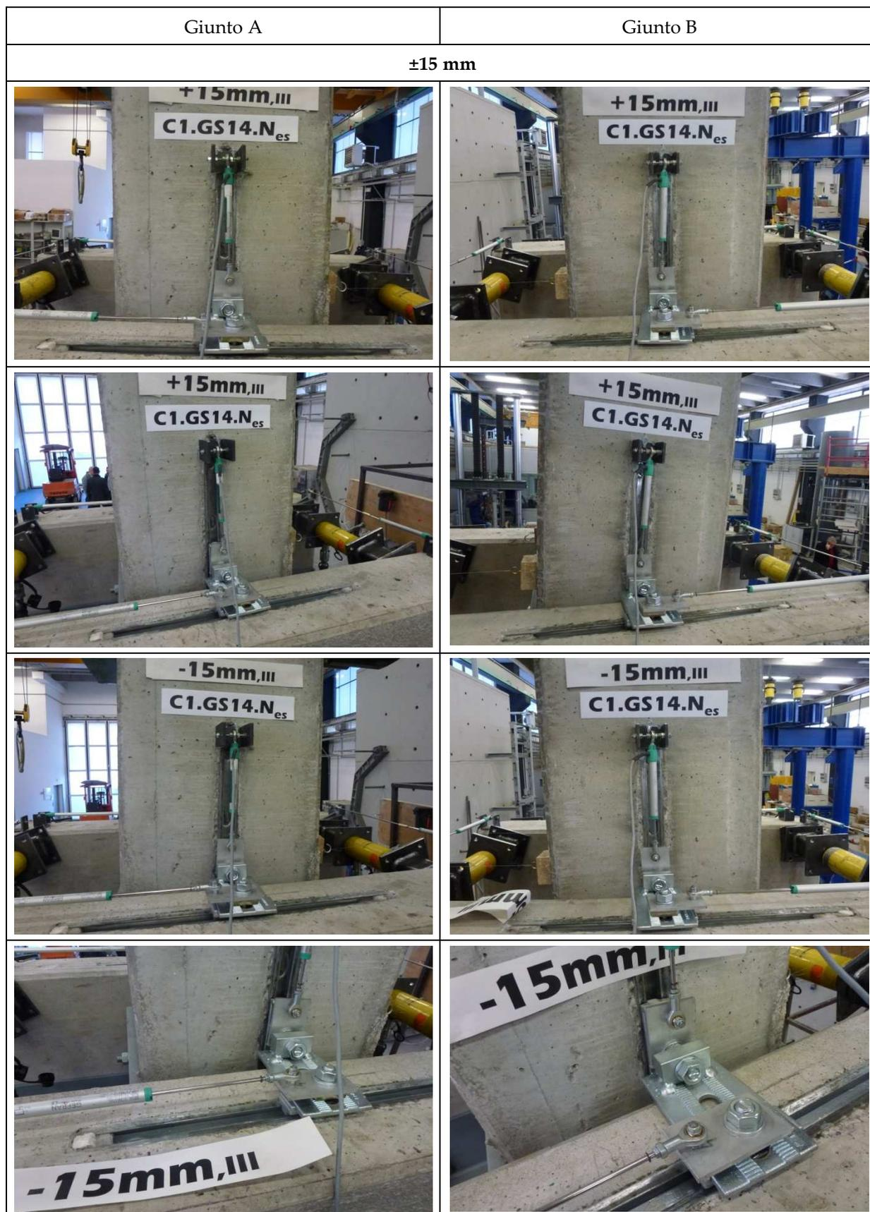
Figura 4.20: Collegamenti A e B al terzo ciclo a uno spostamento pari a  $\pm 15$  mm
