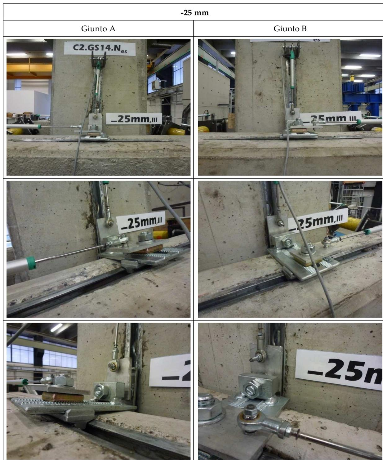
Figura 4.45: Collegamenti A e B al terzo ciclo a uno spostamento pari a  $\pm 25$  mm
