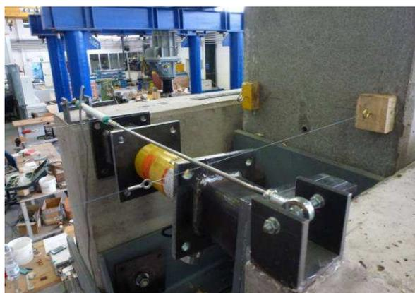
*Figura 3.6: Strumenti a filo per la misura degli spostamenti orizzontali del pilastro*
