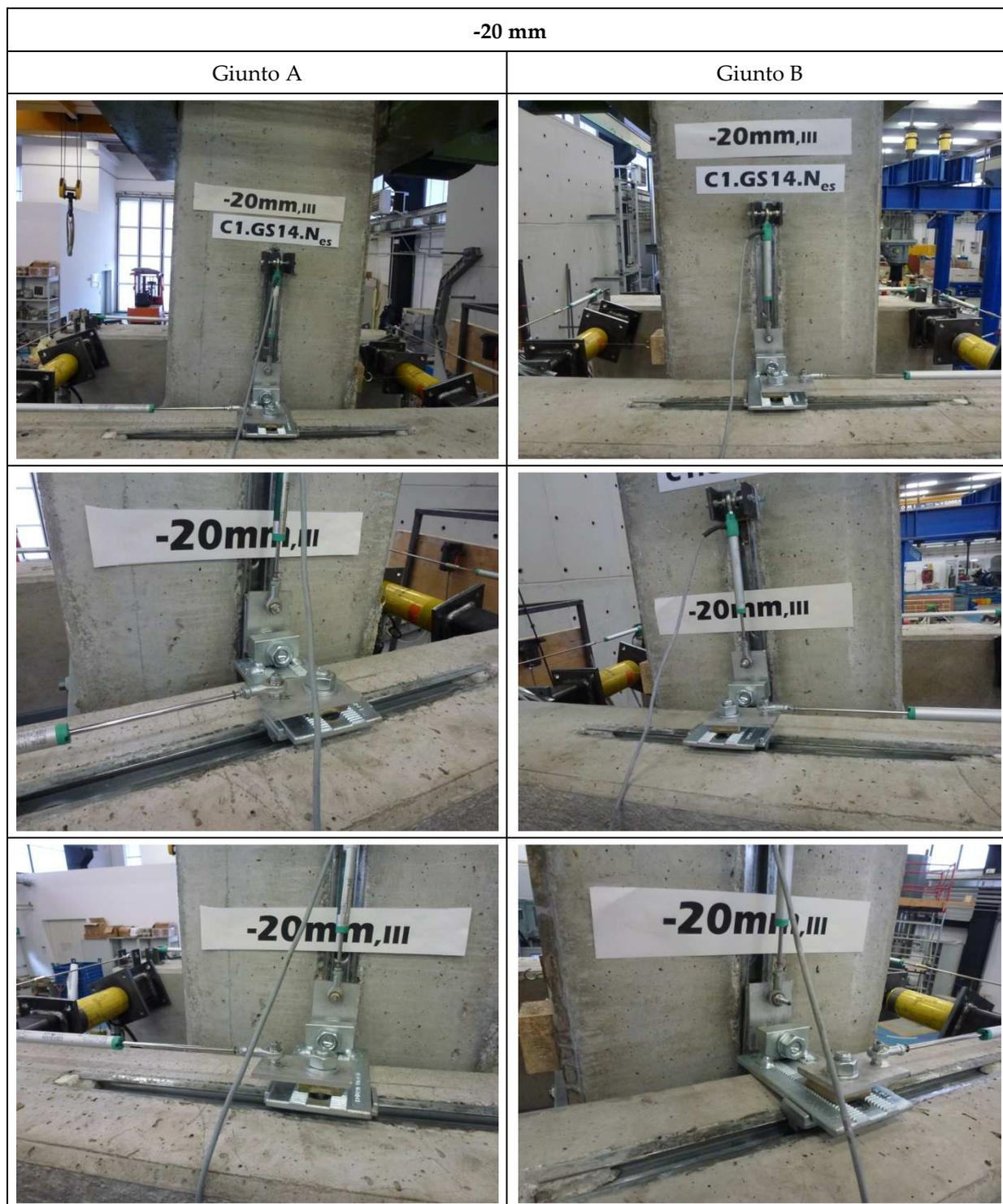
Figura 4.21: Collegamenti A e B al terzo ciclo a uno spostamento pari a  $\pm 20$  mm
