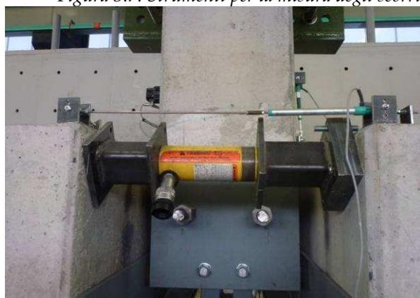
*Figura 3.8: Strumenti per la misura delle rotazioni dei pannelli laterali.*
