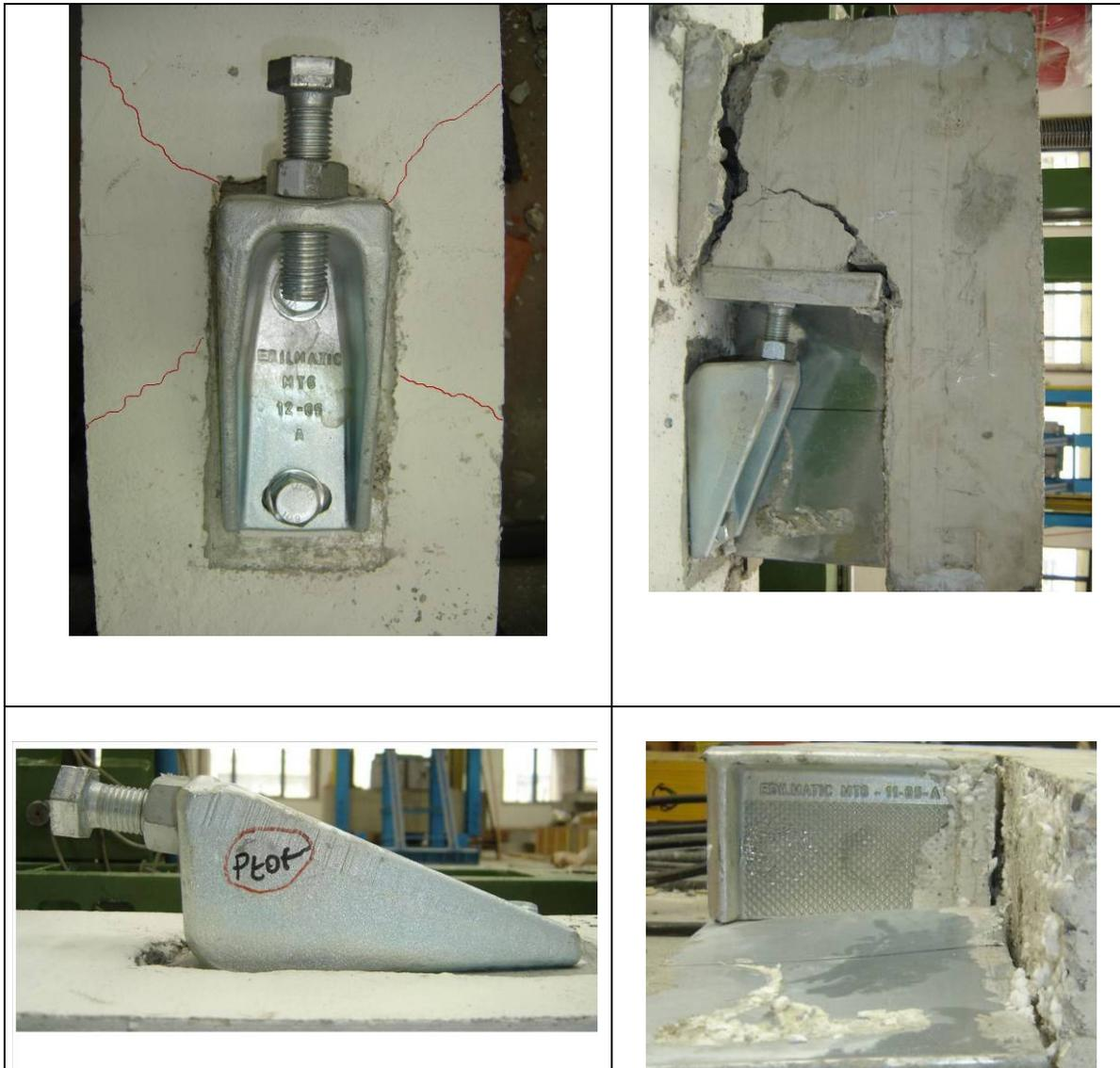
*Fig. 4.60. Mt6-0,5L-60: Danneggiamento del pilastro, del pannello e degli inserti al termine della prova.*
