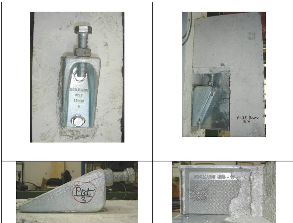
*Fig. 4.68. Mt6-0,5L-20: Danneggiamento del bullone e della mensola al termine della prova*
