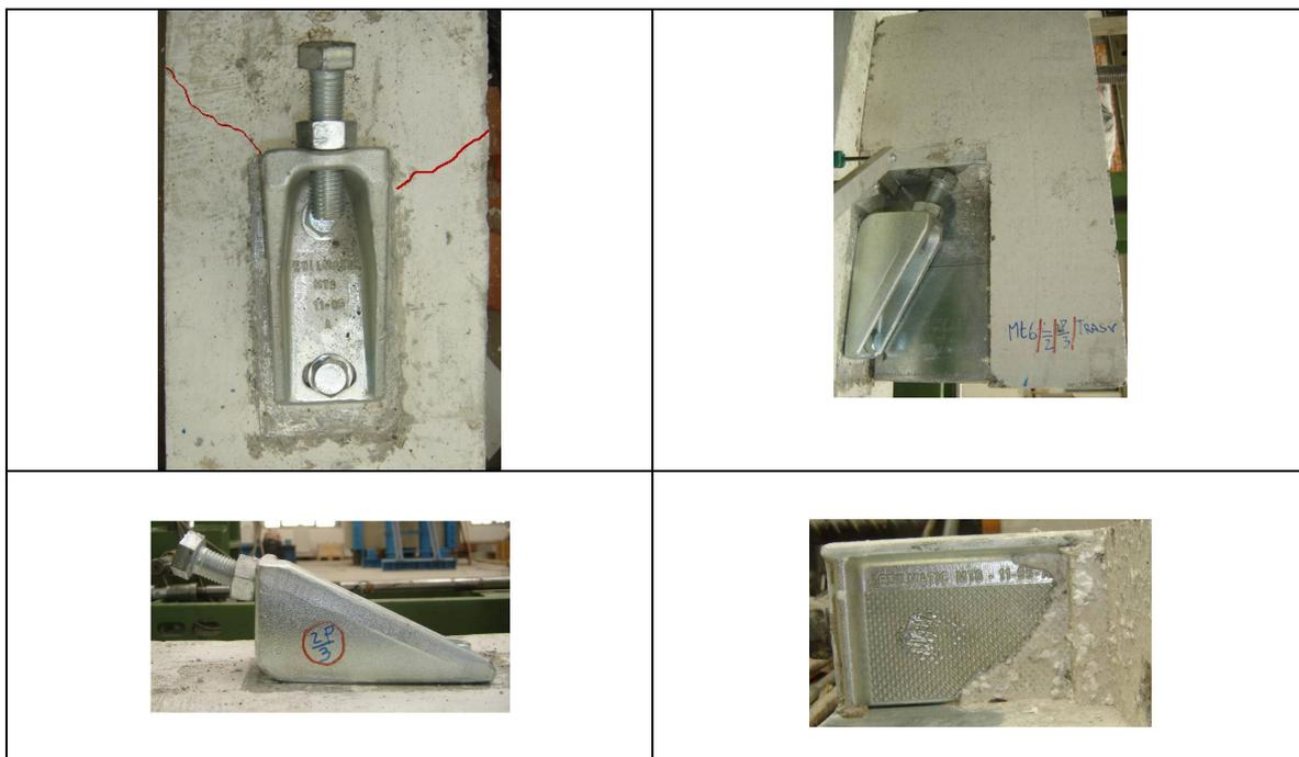
Fig. 4.63. Mt6-0,5L-40: Danneggiamento del pilastro e del bullone al termine della prova.
